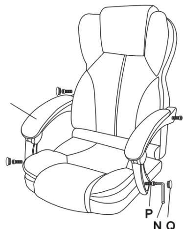
Befestigen Sie zuerst die Rückenlehne (1) an der Sitzfläche, dann befestigen Sie die beiden Armlehnen (3) mit den dafür vorgesehenen Schrauben (g). Ziehen Sie die Schrauben mit dem Schlüssel (h).
