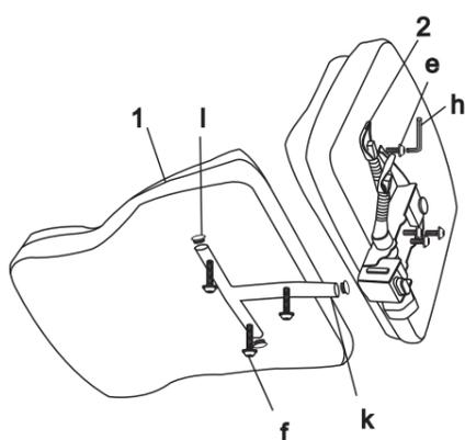
a. Befestigen Sie die Mechanik (2) auf der Sitzfläche (j) mit den dafür vorgesehenen Schrauben (e) und ziehen Sie diese mit dem Schlüssel (h) fest.
