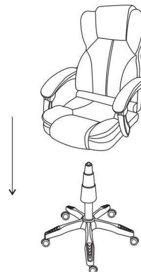
Stecken Sie nun das fertig montierte Oberteil auf die Gasdruckfeder. Hier auch wieder ohne Druck und Kraftaufwand. Die Gasdruckfeder muss in die große Öffnung der Mechanik gesteckt werden.
