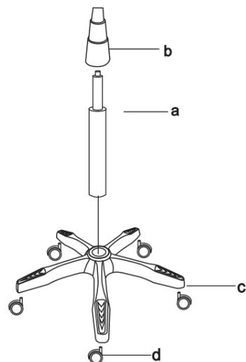
Drücken Sie die Rollen (D) in die fünf Öffnungen des Fußkreuzes (C).
