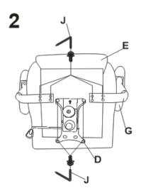
Befestigen Sie die Mechanik (D) unter der Sitzfläche (E) mit den dafür vorgesehenen Schrauben und ziehen Sie diese mit dem Schlüssel (J) fest.
