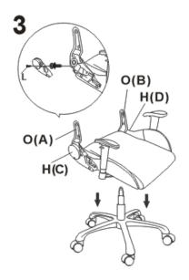
Stecken Sie die Sitzfläche mit den montierten Armlehnen auf die Gasdruckfeder.
