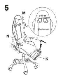
Montieren Sie die Fußstütze (K) unter der Sitzfläche. Ziehen Sie alle Schrauben mit dem Schlüssel (J) fest.
